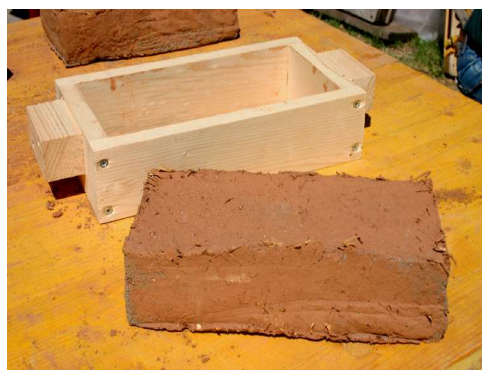
Esempio di compattazione di mattoni in terra cruda e paglia, eseguiti durante il laboratorio del corso “Costruire in terra cruda”, lug.2007.
